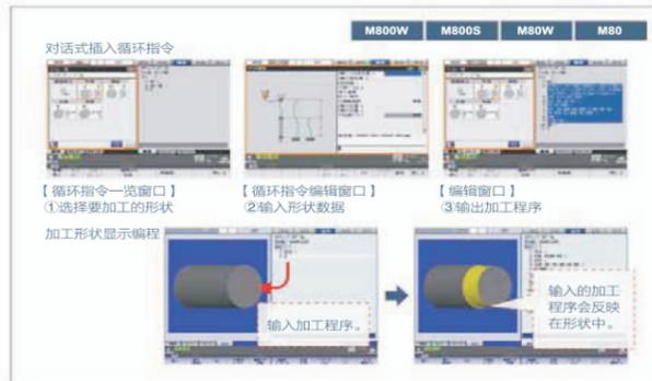
对话式编程、刀具测量操作及工件坐标系补偿等大幅提高了面向车床的易用性。
