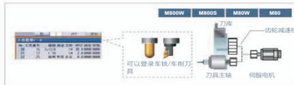
在车床中，应用高速高精度控制和SSS控制的铣削加工成为可能。而且使伺服驱动单元+伺服电机的刀具主轴也成为了可能。
